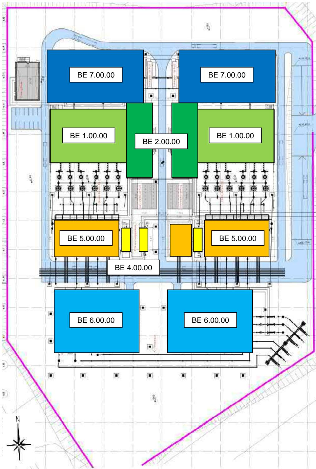
Abbildung 2: Betriebseinheiten der Konverterstation. Nicht dargestellt ist BE 8.00.00, da diese Anlagenteile sich an verschiedenen Stellen auf der restlichen Freifläche befinden. In pink dargestellt ist die Grenze der Konverterfläche.
