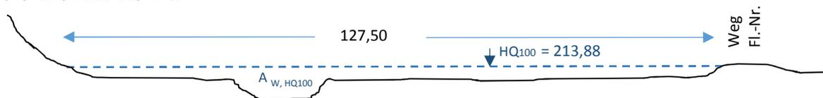
Abflussquerschnitt Bestand gesamt für HQ<sub>100</sub> (aus Plan)
